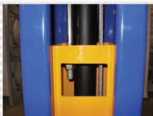
Увеличенный профиль колонн, тросовая синхронизация
