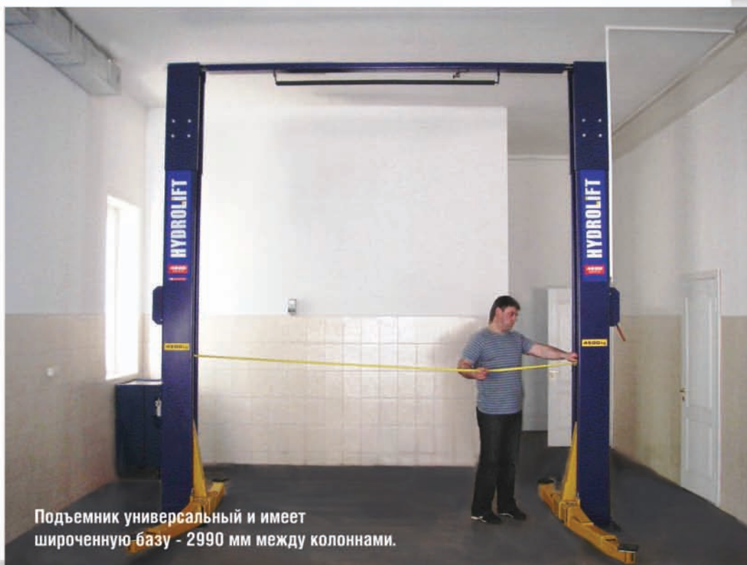
Гидравлический подъемник HYDROLIFT 4500 симметрично-асимметричной конструкции, грузоподъемностью 4,5 тонны. VALEX, США
