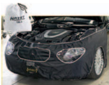
Подходит для работ при включенном двигателе
